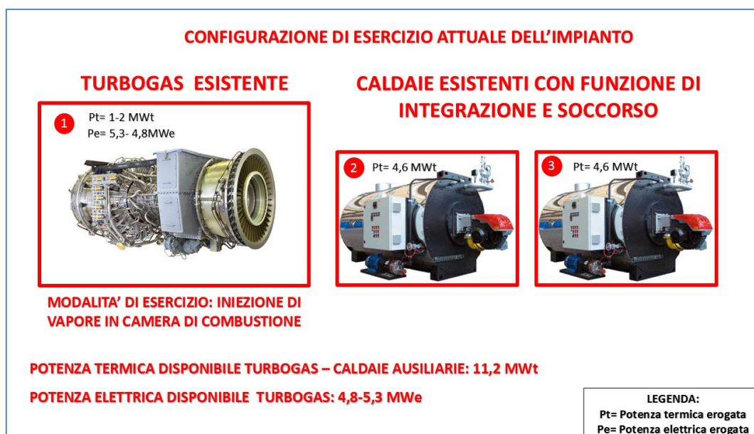
Fig.1: Configurazione di esercizio attuale dell'impianto
