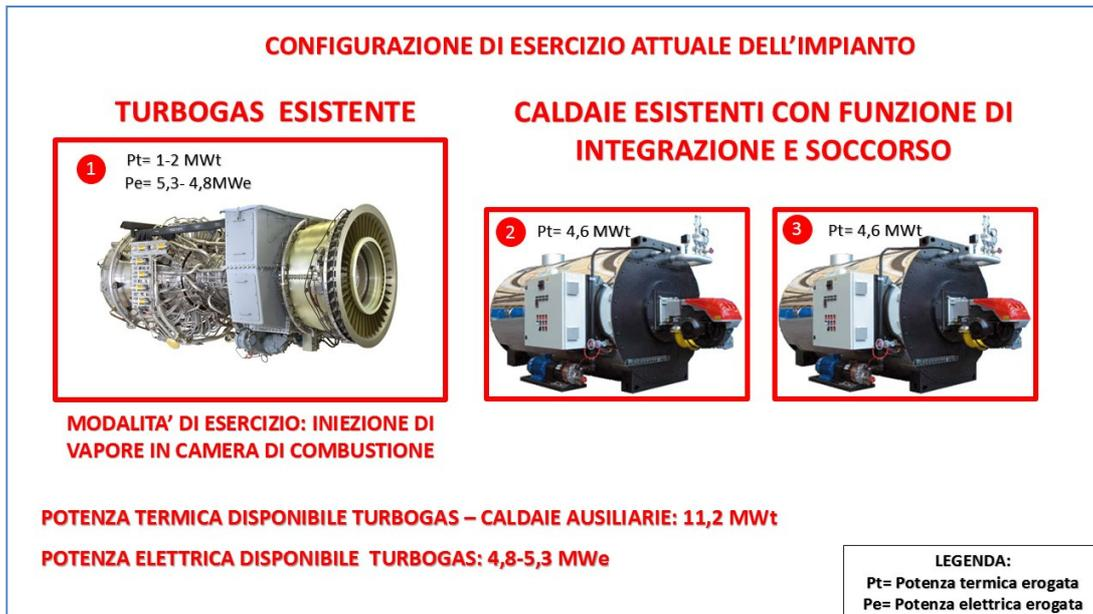
Fig. 1 Configurazione attuale d'impianto
