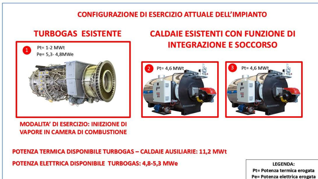
Fig.1 Configurazione attuale impianto (turbina in modalità "iniezione di vapore in camera di combustione)
