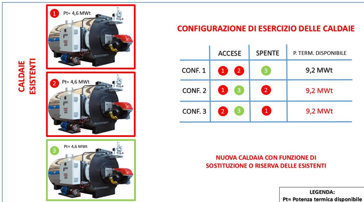
Fig.2: Modalità di esercizio delle caldaie nelle condizioni post-interventi
