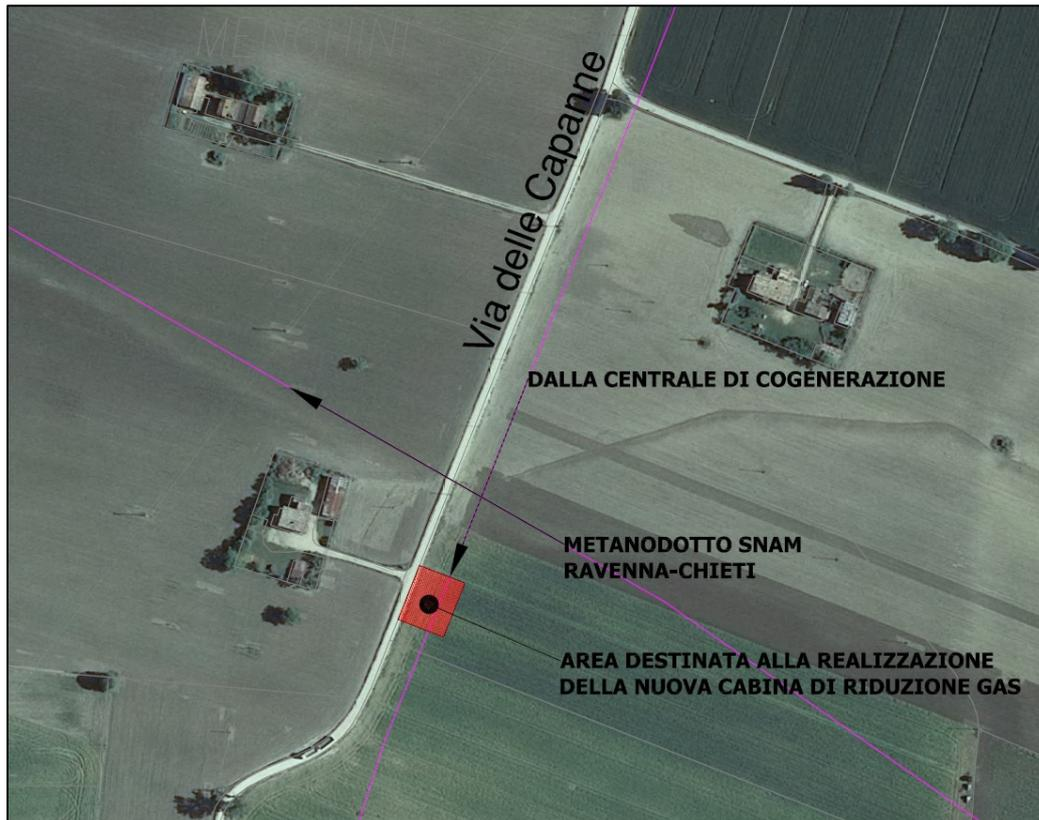
Fig. 1 Area destinata alla realizzazione della nuova cabina di riduzione del gas
