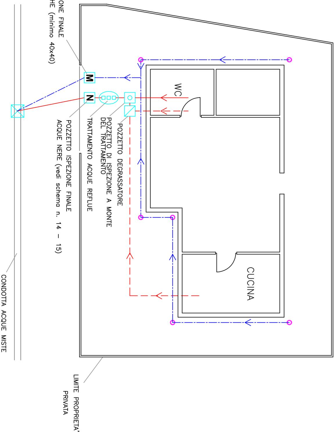
(verificare la necessità di trattare le acque "grigie" con pozzetto degrassatore prima di convogliarle nel sistema di trattamento)
