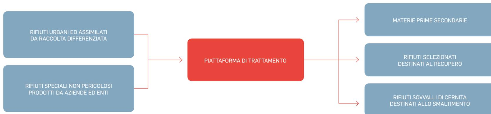
Schema di funzionamento dell'impianto di selezione
