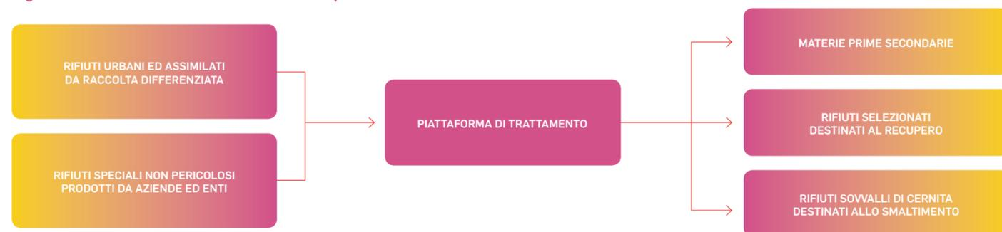
La piattaforma di trattamento è composta da un impianto di cernita e da una pressa in grado di trattare da 6 a 10 tonnellate/ora di rifiuti.
