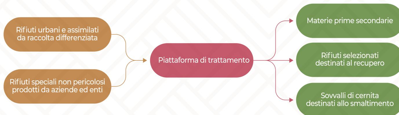
Fig. 8.42 - Schema di funzionamento dell'impianto di selezione
